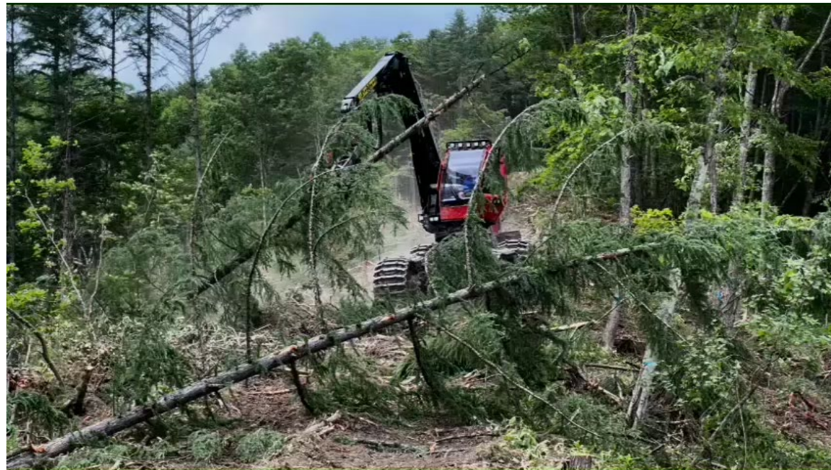
Komatsu 951XC Wheeled harvester 全長:8m, 重量:23,275kg @2025、帯広
