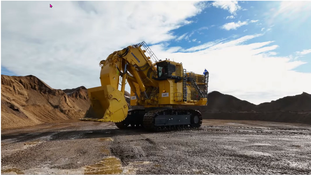
コマツ PC9000 機械質量:883トン, バケット容量46m 3
